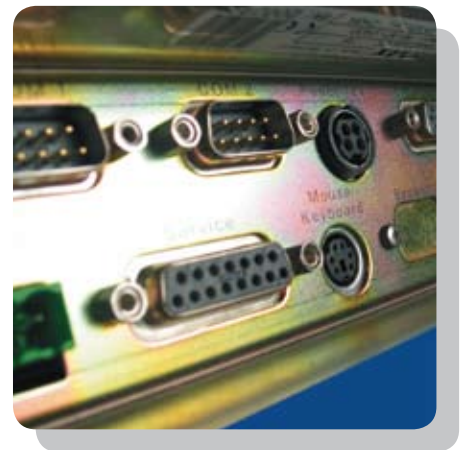
Szczegół powierzchni przyłączeniowej zintegrowanej płyty głównej NOAX N7
